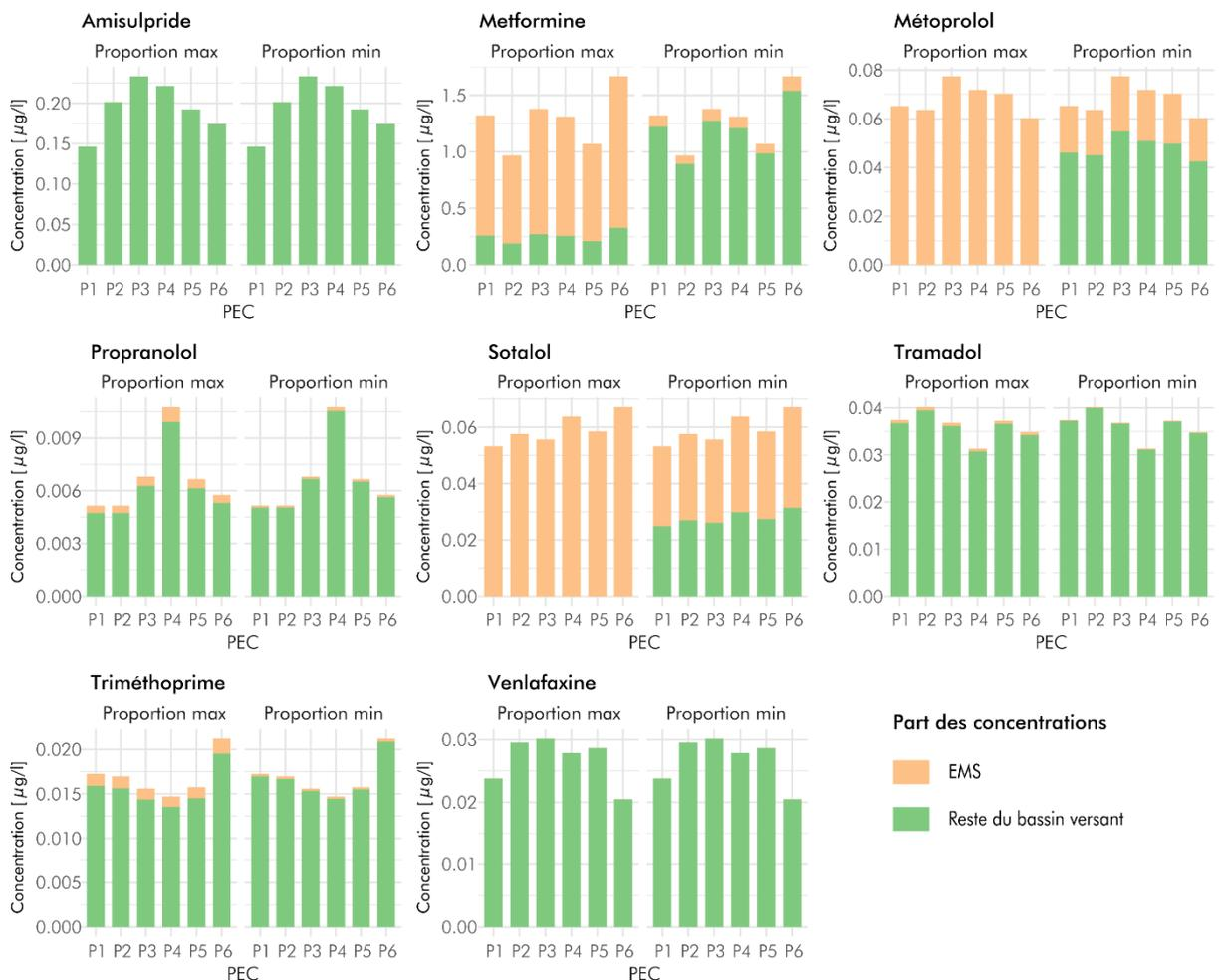
Figure 17 PEC dans le milieu récepteur d'après les mesures en sortie de STEP avec les proportions min et max de l'EMS
